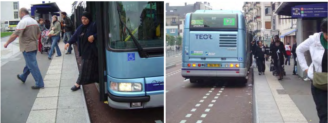
Photo 1 et 2, TEOR, mai 2007, pour des raisons de maintenance le guidage optique est maintenu inactif.
