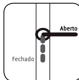
Figura 15: Uma torneira de freio numa locomotiva (acidente na estação de Lyon)
